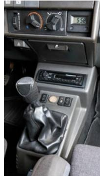
Die Drucktasten für die Richtungswahl an der Mittelkonsole erinnern an den flachen Alpine-Bruder A110, die „blind“ bedienbare Lenkstockhebel-Lösung der Bau-Basis ist freilich praktischer. Knackig und leichtgängig präsentiert sich die manuelle Schaltung beim GTE, im Paket gegen rund 440 Euro gab es damals elektrische Fensterheber plus Zentralverriegelung mit Infrator-Fernbedienung, aka PLIP
