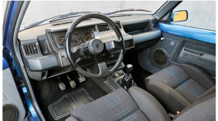
Mit Ausnahme der fehlenden Ladedruckanzeige im Drehzahlmesser entspricht das GTE-Cockpit dem des giftigeren GT Turbo, es gibt also das gleiche griffige Dreispeichen-Lenkrad – und auch ein gelochtes Gaspedal. Überraschend fein: die Sitzposition
